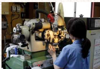
△超硬工具作成のための 研磨を行っている様子
