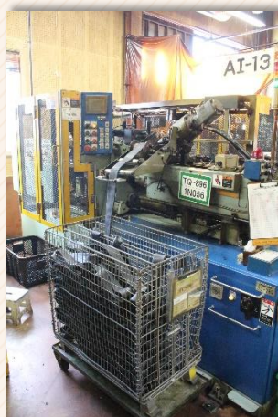
▲ゴム部品を作る射出成形機を19台備える
